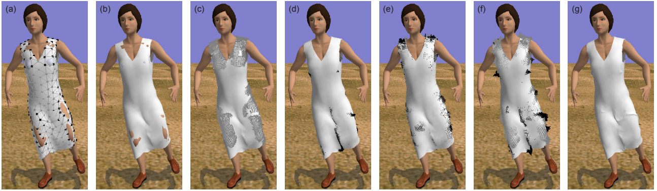
図 3: 衣服の表面形状の計算手順。(a) 少数粒子による動力学シミュレーション。黒の粒子は人体モデルとの接触を表す。(b) 細分割手法により生成されたなめらかな詳細モデル。(c) 詳細モデルのめり込み回避処理。灰色の点はめり込み回避処理された粒子を表す。(d) 詳細モデルの各粒子における長さ。黒いベクトルは縮んでいる粒子を示す。(e) 詳細モデルの各粒子に働く垂直方向の力。黒いベクトルは周囲から押されている粒子、灰色のベクトルは周囲から引かれている粒子を表す。(f) 曲面制御の可視化。灰色のベクトルはめり込み回避処理による変形、黒いベクトルは弾性力と伸縮状態に応じた変形を表す。(g) 最終的に生成された衣服の表面形状。
