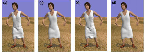
図6: 法線の計算。(a) PN Triangles による生成曲面の法線を面の法線から計算したもの。(b) 同じ曲面の法線を PN Triangles の提供する補間法線を使用して計算したもの。(c) 提案手法によって生成された表面形状の法線を面の法線から計算したもの。(d) 同じ表面形状の法線を(b)と(c)をブレンドして計算。
